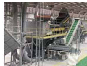
台湾Boretch社製プラスチックボトル 洗浄リサイクル装置
