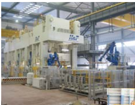
タンデムプレスライン (写真提供:株式会社エイチアンドエフ)
